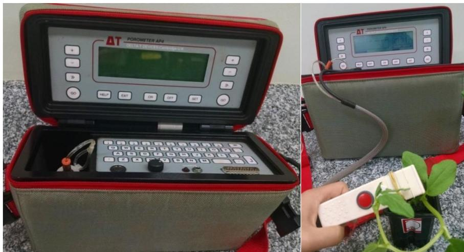
A condutância estomática foi obtida através do equipamento portátil Porometer AP 4 Delta T, apresentado na Figura 3. O aparelho realiza a medida da condutância pela comparação da taxa precisa de umidificação dentro de uma pequena área do sensor.
