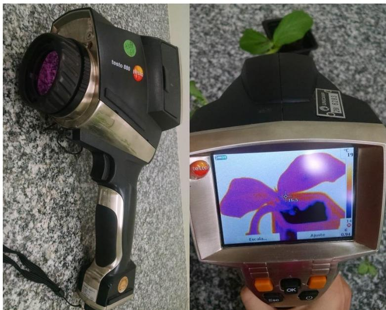
As imagens foram obtidas por meio da câmera termográfica Testo®, apresentada na Figura 2, modelo 880, detector infravermelho de 2.3 Megapixels de resolução, onde as escalas de temperaturas são indicadas por gradientes de falsa cor.
